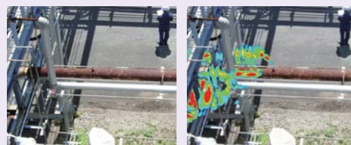
通常のカメラ(左)では見えないガス漏れを、ガス監視システム(右)では可視化でき、漏洩箇所、ガスの流れも特定
